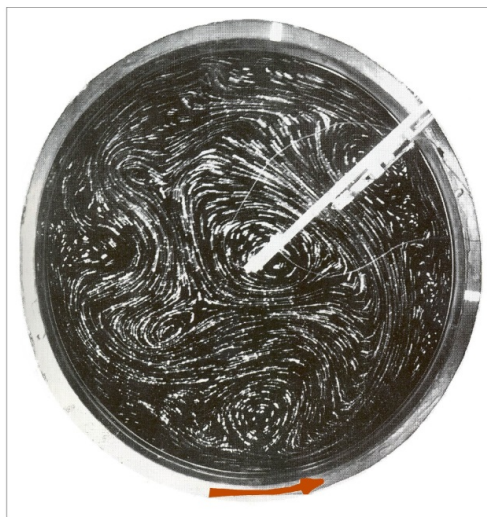
7.13. ábra: Forgómedencés légkör-szimulációs kísérlet (Forrás: D.H. Fultz, University of Chicago, Hydrodynamics Laboratory, 1951)
