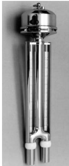
15.3. ábra: Az Assmann-féle pszichrométer. Árnyékolt, fémborítású műszer a száraz-nedves hőmérőpárral, tetején az aspirátorral, ami a levegő áramlását biztosítja a mérés során.
