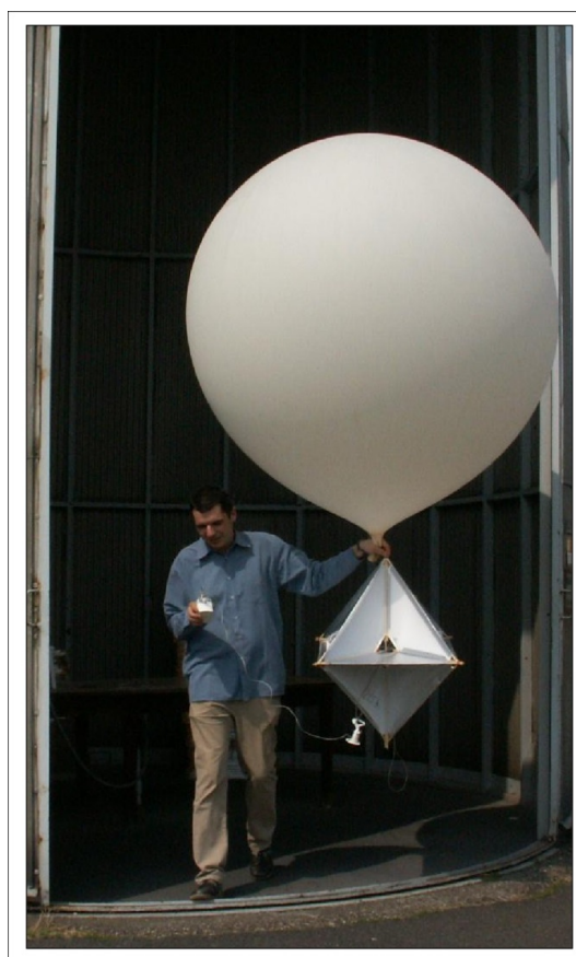
12.3. ábra: Rádiószonda felbocsátás a Budapest-Pestszentlőrinc meteorológiai állomásról. A meteorológiai szenzorokat (elektromos hőmérő, nedvességmérő, esetenként légnyomásmérő egy hidrogénnel töltött ballon juttatja a légkörbe, mintegy 30–35 km-es magasságig. Adott magasságokban a szél sebességét és irányát a szonda rádiós követése alapján számítják.
